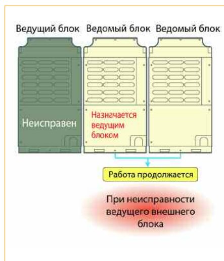
Рис. 14. Робота модульної мультизональної системи з несправним блоком
